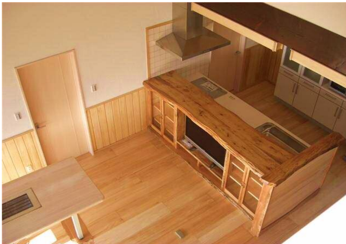
桐床 : 厚24×幅240×長1820mm 自然塗料塗装 桐腰壁セット : 厚12×幅150×長1820mm 塗装 幅木・笠木付 桐テーブル : 厚33×幅750×長1600mm 自然塗料塗装 特注板
